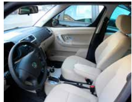
Z vgrajenimi komandami za ročno upravljanje (foto arhiv Zveze)
