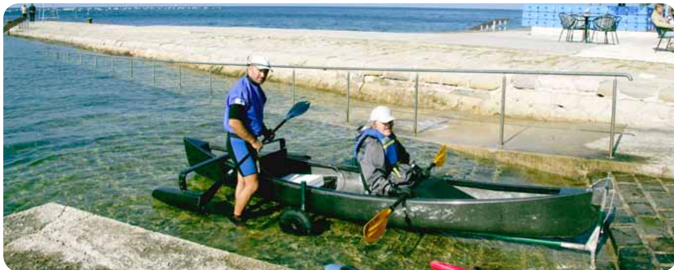
Moj 1. spust v morje. Pod kanu je nameščen enoosni voziček, na katerem je kanu. V dovolj globoki vodi se voziček potopi, kanu pa zapluje.
